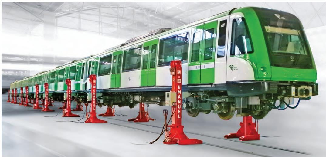
Elevatoare cu coloane mobile, ce pot lucra in seturi de cate 4, 8 sau 16 coloane, atat simultan, cat si independent. Capacitati de ridicare de la 5 tone la 50 tone per coloana.
